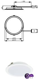
Technische Daten Philips LED Downlight Ledinaire DN065B Metall Weiß 19W 2000lm 110D - 830-840-865 CCT | 225mm - Ausschnitt 200mm - IP20
